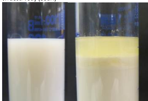
Obr. 3 Stabilní a nestabilní emulze při extrémní hodnotě tvrdosti vody (80dH)
